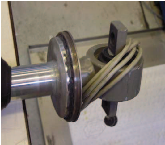
Rys. 3. Tensometr zamocowany do tłoczyska amortyzatora (pod metalową osłoną)
