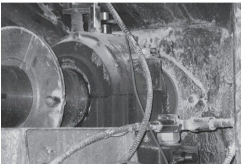
Rys. 2. Sposób pomiaru drgań czujnikami w dwóch prostopadłych kierunkach
