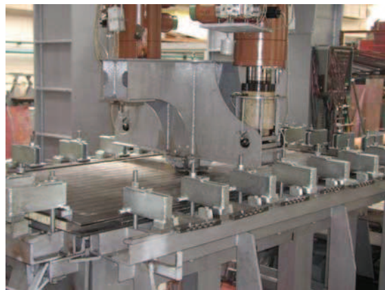
Rys. 8. Model w trakcie badań zmęczeniowych
