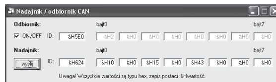
Rys. 4. Testowy nadajnik / odbiornik CAN
