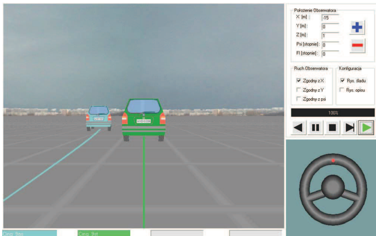
Rys. 7. Animacja ruchu pojazdów – trajektorie ruchu po zatrzymaniu pojazdów, widok „z tyłu” (pojazd nominalny, pojazd z asymetrycznie działającymi hamulcami)
