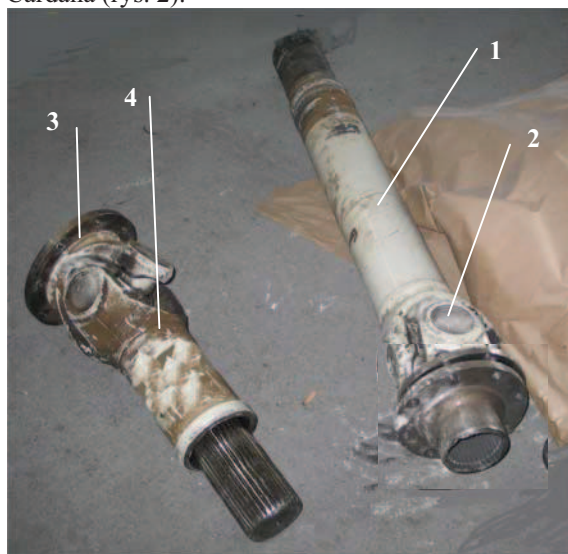
Rys. 2. Wał z przegubami Cardana: 1-widełkowo-wielowypustowy wał rurowy, 2-krzyżak, 3-tarcza przegubu, 4- widełkowo-wielowypustowy wał pełny
