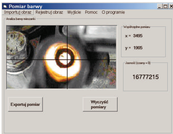
Rys. 8. Ocena jasności obrazu spalania mieszanki bogatej z zastosowaniem opracowanego programu
