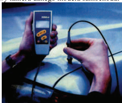
Rys. 2. Pomiar grubości powłoki lakierowej przy pomocy testera
