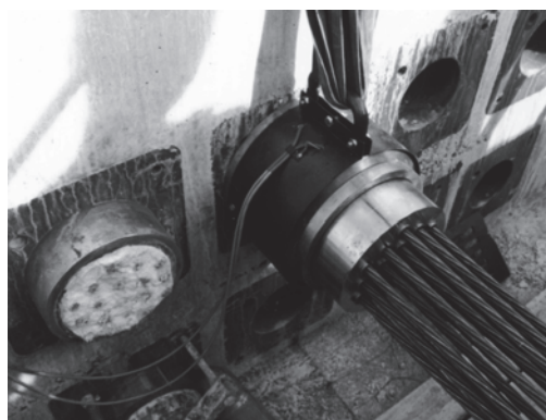
Rys.12. Czujnik siły zamocowany na obiekcie podczas weryfikacji
