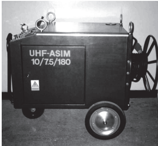
Rys. 3. Widok agregatu napędowo-sterującego UHF-ASIM 10/7,5/180
