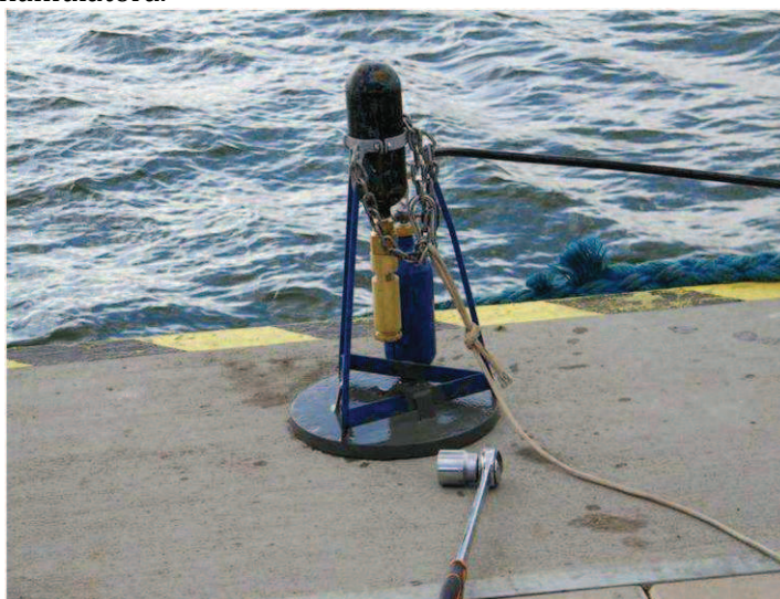
Rys. 5. Model działka pneumatycznego ze sprężyną i akumulatorem.
