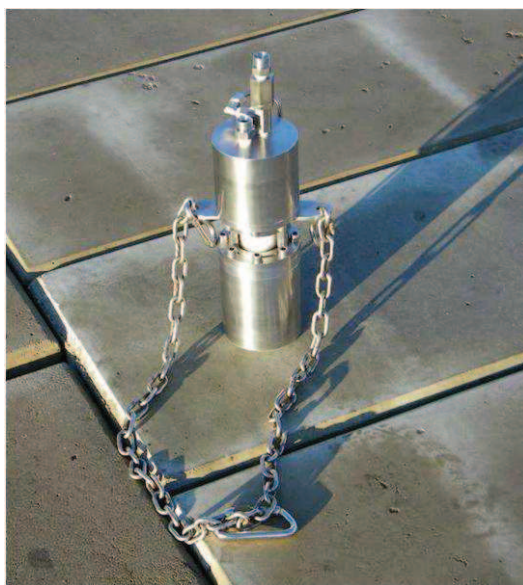
Rys. 6. Prototyp działka pneumatycznego pracującego przy ciśnieniu do 200 atm.
