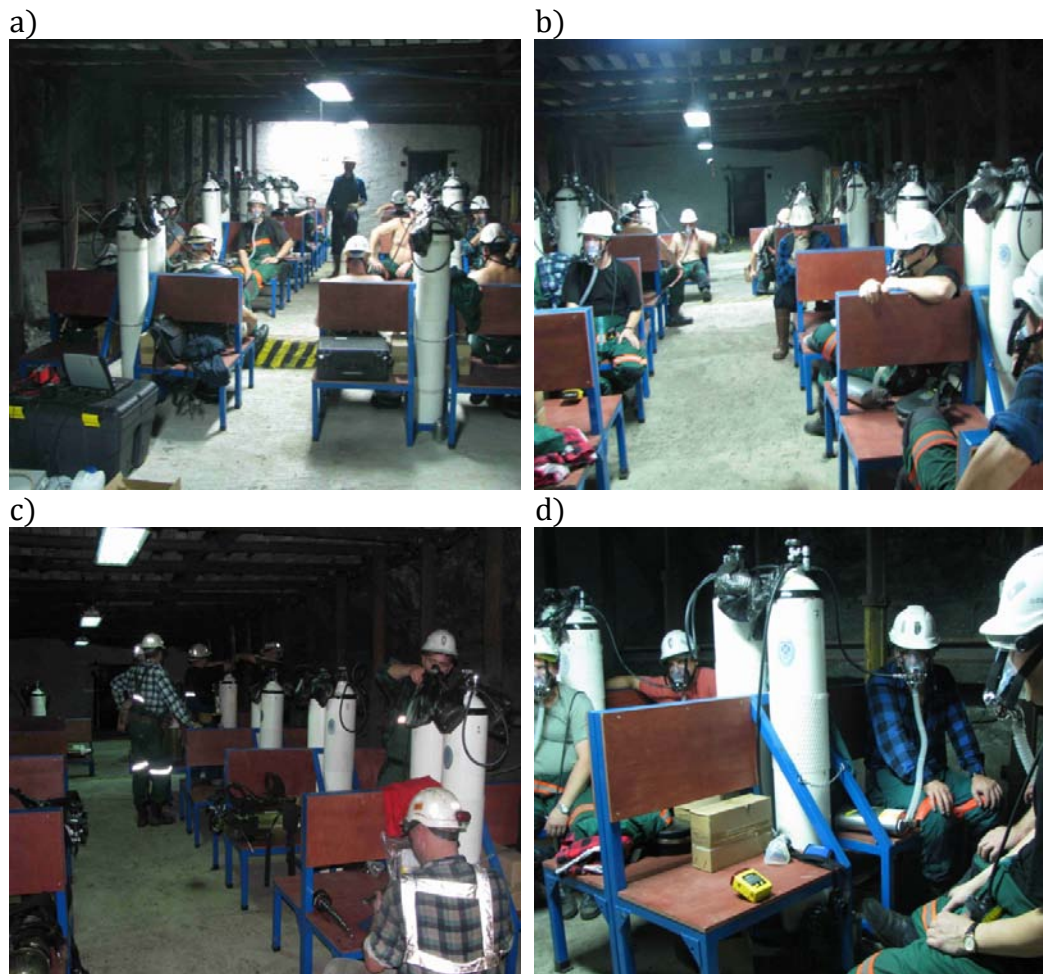
Rys.2. Rozmieszczenie sprzętu podczas badań: a) stanowisko monitoringu b) ratownicy oddychający poprzez inhalatory z podłączonymi pochłaniaczami CO 2 c) stanowisko pomiaru wilgotności i temperatury d) jedno ze stanowisk pomiaru stanu zagrożenia w komorze
