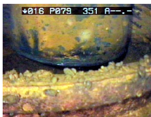
Rys. 13. Uszkodzone zagłowiczenia odwiertu B3-4BRe – Morze Bałtyckie głębokość 80 metrów
