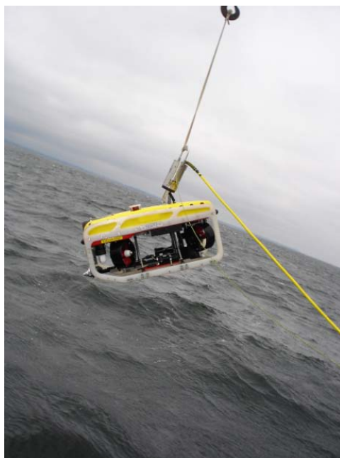
Rys. 14. Zdalnie sterowany pojazd głębinowy typu ROV „Falcon”
