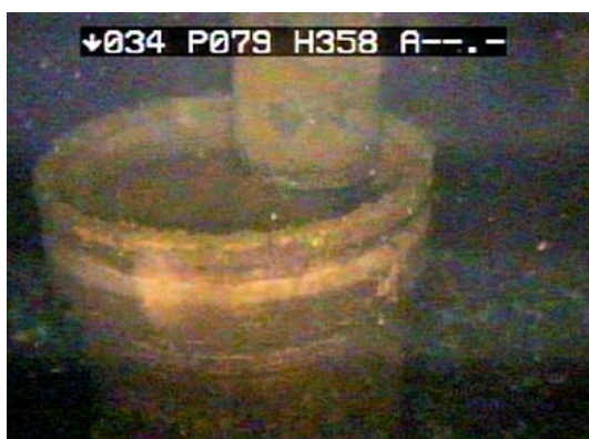
Rys. 13. Uszkodzone zagłowiczenia odwiertu B3-4BRe – Morze Bałtyckie głębokość 80 metrów
