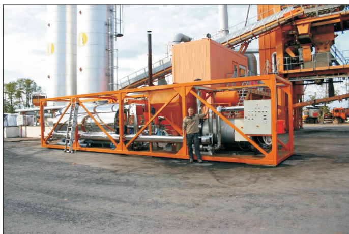
Fot. 1. Widok polskiego zestawu do modyfikacji asfaltu gumą (fot. H. Koba)
