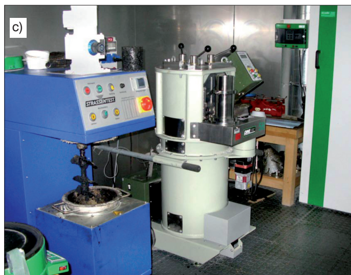
Fot. 4. Widok Akredytowanego Laboratorium Badawczego Obiektów Infrastruktury Transportowej – Pracownia Drogowa: a) aparatura do badań mieszanek mineralno-asfaltowych i betonów – zmęczenie, koleinowanie, prasa wytrzymałościowa; b) zestaw aparatury do badań asfaltów: aparat próżniowy, PiK, duktylometr, prasa Marshalla; c) zestaw do wytwarzania mieszanek mineralno-asfaltowych, prasa żyratorowa
