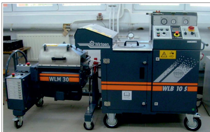
Fot. 1. Urządzenie do wytwarzania piany asfaltowej i podawania jej do mieszalnika (fot. J. Mrugała)
