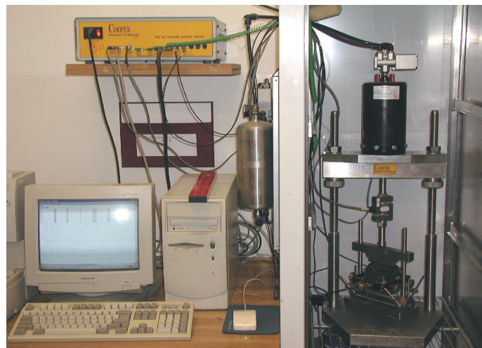
Fot. 1. Stanowisko do oznaczenia dynamicznego modułu sprężystości w aparacie NAT (fot. J. Kuźniewski)
