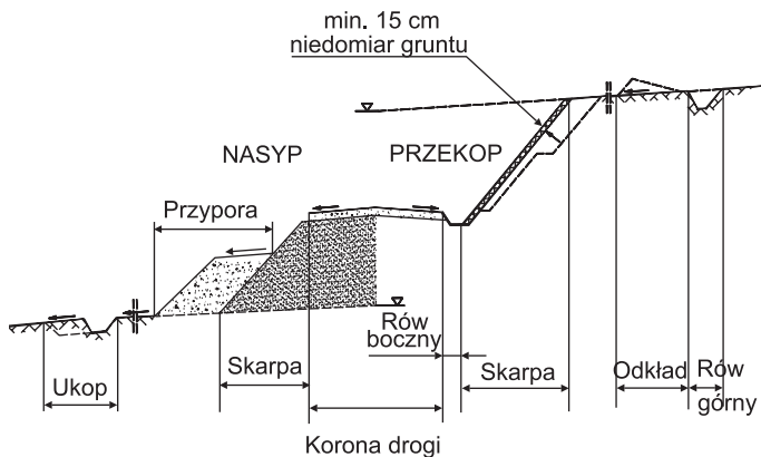
Rys. 6. Zebrana warstwa gruntu (jeśli zachodzi konieczność humusowania; nie dotyczy w przypadku stosowania hydroobsiewu) [13]
