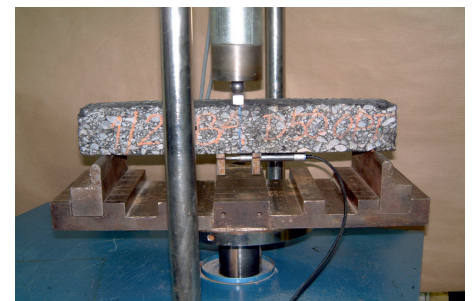
Rys 1. Schemat statyczny i widok próbki w badaniu metodą zginania ze stałą prędkością deformacji (fot. Marek Pszczoła)
