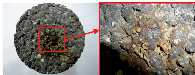
Fot. 2. Źródło przebarwienia. Największe ziarna na fotografii mają wielkość ok. 12 mm (fot. B. Grzesik)
