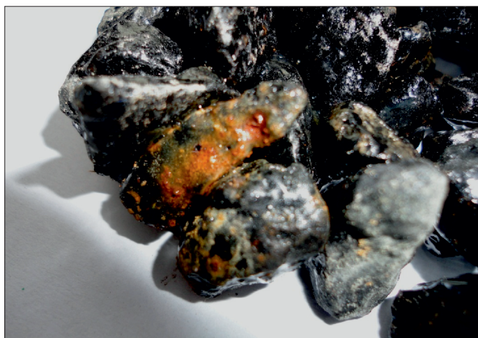
Fot. 8. Rdzawobrunatne wykwity produktów wietrzenia po 60-dniowej ekspozycji na działanie środowiska wilgotnego. Przedstawione ziarna mają wymiar od 8 do 11 mm (fot. B. Grzesik)
