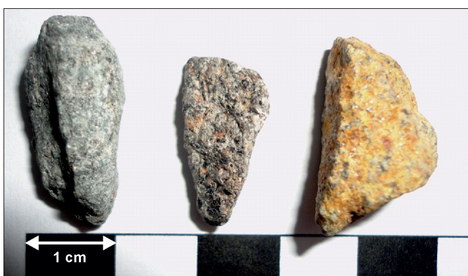
Fot. 6. Charakterystyczne zabarwienie ziaren amfibolitu, kolejno od lewej: A-Zi, A-Cz oraz A-Cz z widocznymi efektami wietrzenia w postaci rdzawego zabarwienia (fot. B. Grzesik)
