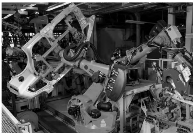
Rys. 1. Zautomatyzowane stanowisko montażu bocznego elementu nadwozia samochodowego
