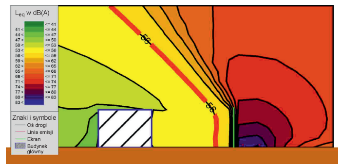
Rys 3. Mapa przekroju poprzecznego rozprzestrzenienia dźwięku: ekran o długości 500 m
