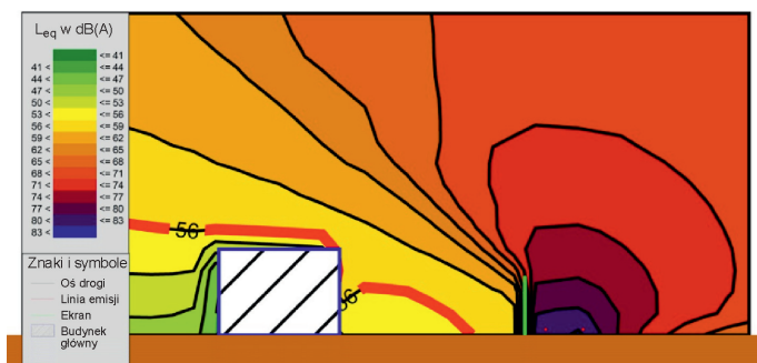
Rys 4. Mapa przekroju poprzecznego rozprzestrzeniania dźwięku: ekran o długości 280 m oraz cicha nawierzchnia
