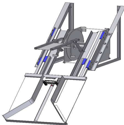
Rys. 1. Wstępna koncepcja systemu wodowania opracowana dla pojazdu AC-ROV [3].
