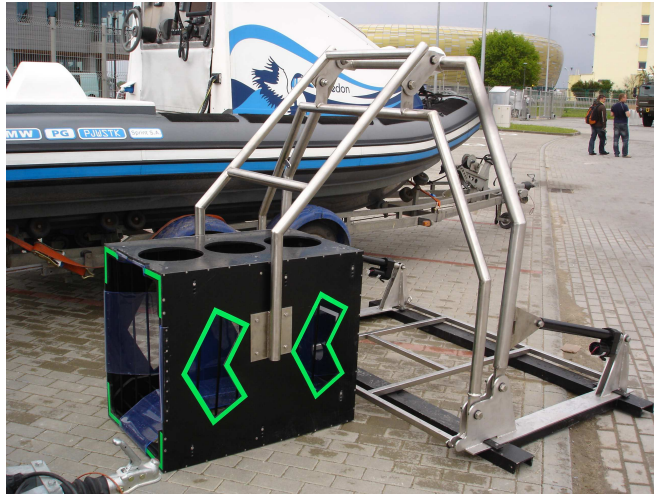
Rys. 7. Zespół ram systemu wodowania pojazdu ROV z garażem podwodnym przygotowany do montażu na pokładzie USV.
