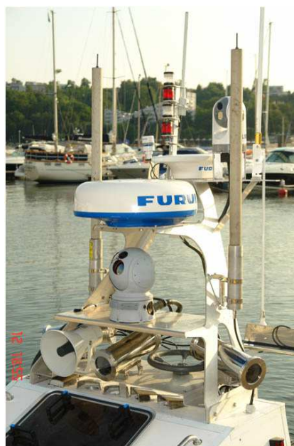
Rys. 3. Rozmieszczenie urządzeń nawigacyjnych i anten systemu łączności na maszcie.
