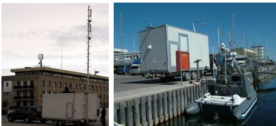
Rys. 5. Kontenerowe stanowisko sterowania USV.
