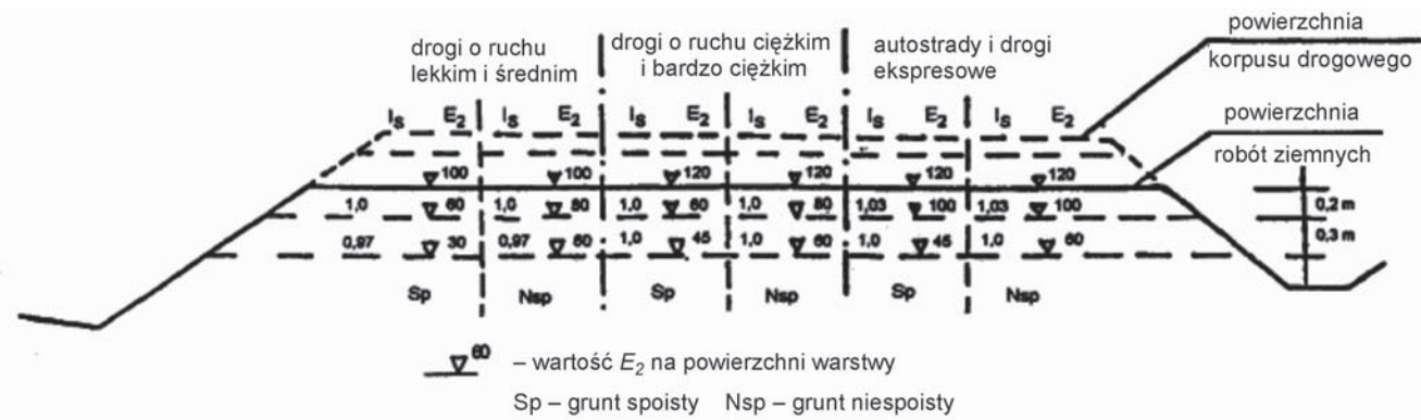
Rys. 9. Wymagania co do wskaźnika zagęszczenia I_s i wtórnego modułu odkształcenia E_2 (MPa) w wykopach według [12]
