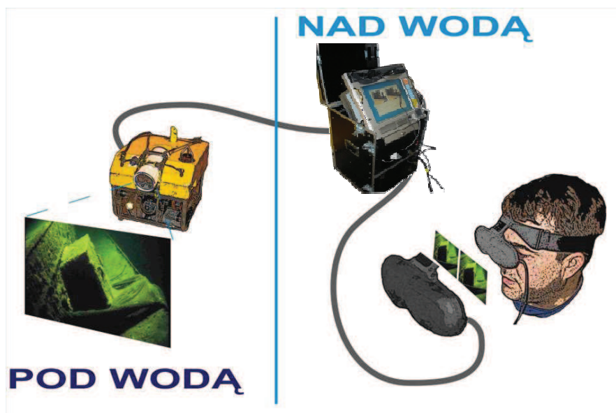
Rys. 5. System przestrzennej obserwacji obiektów podwodnych w czasie rzeczywistym ARGOOS.
