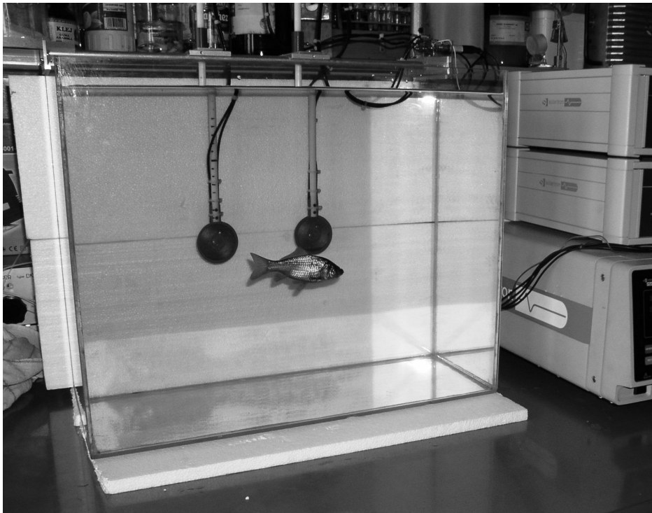
Rys. 1.2. Układ pomiarowy. Elektrody w układzie koplanarnym (umieszczone w jednej płaszczyźnie).
