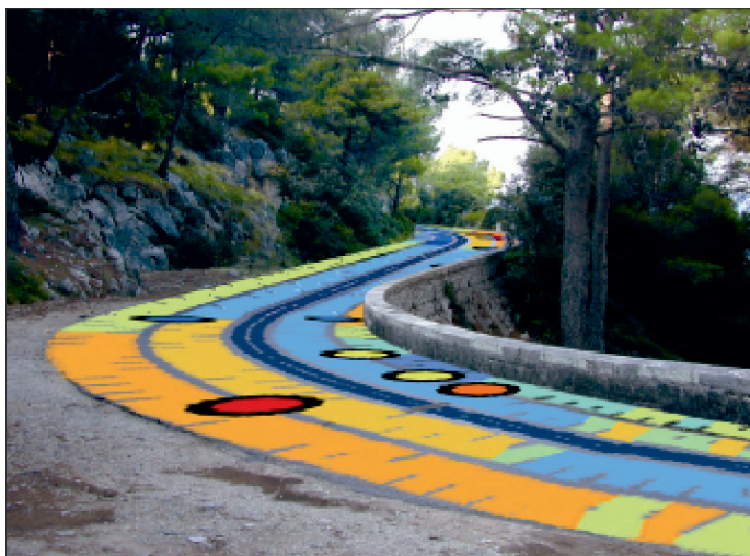
Rys. 2. Korelacja pomiędzy właściwościami przeciwpoślizgowymi a wypadkami drogowymi (kółkami oznaczono miejsce zdarzeń, a kolorem ich ciężkość, /kolor czarny oznacza wypadek z ofiarami śmiertelnymi, czerwony – z ciężko rannymi, żółty z lekko rannymi, zielony – bez poszkodowanych; kolor odcinka drogi oznacza poziom właściwości przeciwpoślizgowych: czerwony \mu < 0,38 /najgorszy poziom wskaźnika/, pomarańczowy – gdy 0,38 < \mu < 0,45 , żółty – gdy 0,45 < \mu < 0,59 , zielony – gdy 0,59 < \mu < 0,75 i niebieski – gdy 0,75 < \mu /najlepszy poziom wskaźnika/) [11]
