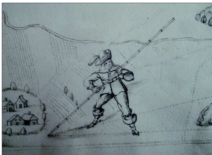
Fot. 6. Pomiar odległości tyczką o długości jednego pręta przy pracach w Królewcu wg Topographia practica... F. Getkanta (Krigsarkivet: Handritade kartverk. 28. Verso: blue label)
