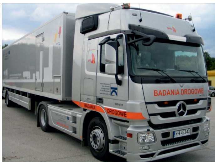
Fot. 2. Pojazd wyposażony w ugięciomierz laserowy TSD
