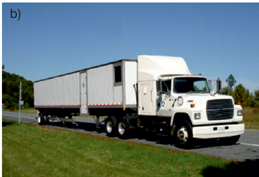
Fot. 1. Ugięciomierze laserowe: a) prototyp TSD (ang. Traffic Speed Deflectometer ) z 2005 r., wykorzystywany przez Duński Instytut Drogowy [ http://www.greenwood.dk ]; b) RWD (ang. Rolling Wheel Deflectometer ) z 2005 r., wykorzystywany w Stanach Zjednoczonych A.P. przez Applied Research Associates dla FHWA [ http://www.ara.com/ ]
