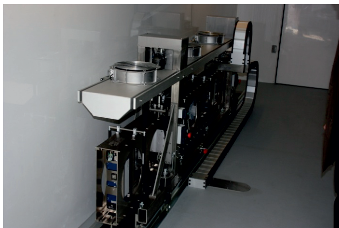
Fot. 3. Wnętrze pojazdu – belka z zainstalowanymi czujnikami laserowymi – element pomiarowy ugięciomierza TSD
