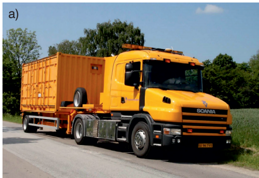
Fot. 1. Ugięciomierze laserowe: a) prototyp TSD (ang. Traffic Speed Deflectometer ) z 2005 r., wykorzystywany przez Duński Instytut Drogowy [ http://www.greenwood.dk ]; b) RWD (ang. Rolling Wheel Deflectometer ) z 2005 r., wykorzystywany w Stanach Zjednoczonych A.P. przez Applied Research Associates dla FHWA [ http://www.ara.com/ ]
