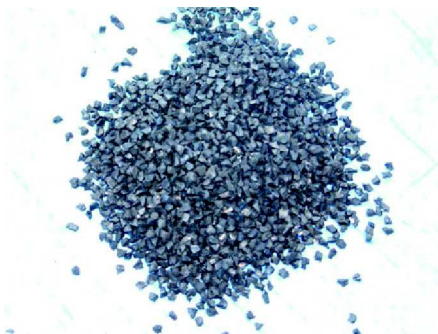
Fot. 2. Materiał pochodzący z przemiału zużytych opon – granulaty gumowe
