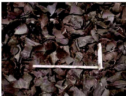
Fot. 1. Materiał pochodzący z przemiału zużytych opon – chipsy gumowe
