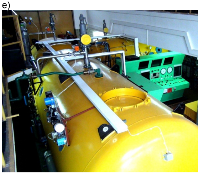
Rys.5. Doświadczalny Głębokowodny Kompleks Nurkowy DGKN-120 a) nurkowie w komorze wodnej kompleksu przygotowujący się do nurkowania b) nurek gotowy do nurkowania c) komputer ze wskazaniami dla nurka d) nurek na stanowisku ergonometru e) kompleks DGKN-120 widok z góry f) system obserwacji i nadzoru eksperymentu.
