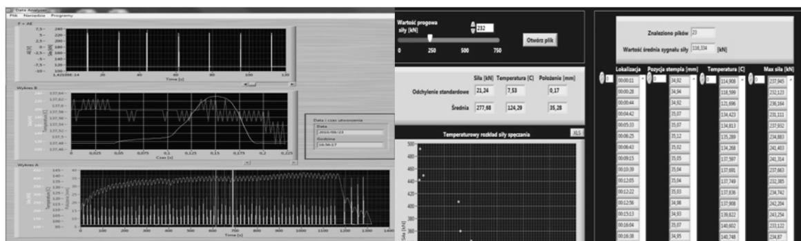
Rys. 11. Widok głównego frontpanelu z aplikacji do podglądu siły w funkcji czasu/przemieszczenia oraz widok panelu do analizy wybranych wielkości z wykorzystaniem filtracji sygnału.
