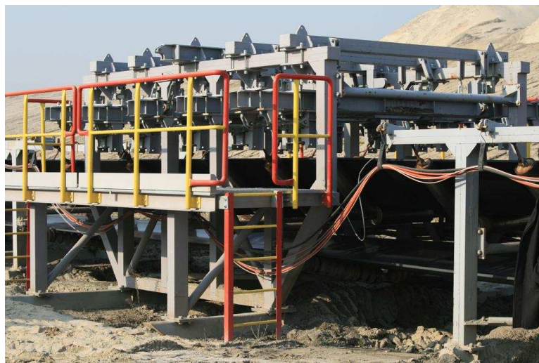
Rys.12. Człon pomiarowy do badania oporów ruchu na pojedynczym zestawie kółkowym. Fig. 12. Measuring segment for investigating motion resistance of single idler set.
