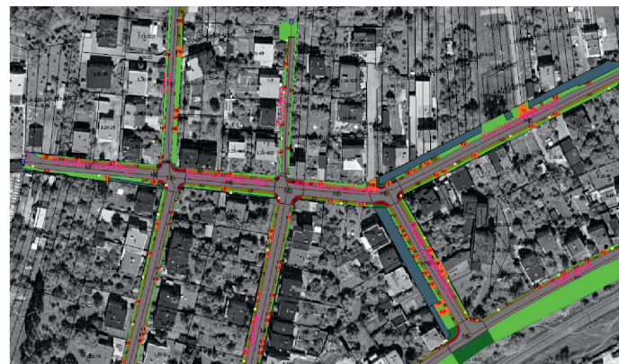
Rys. 5. Fragment powstającej bazy danych oraz mapy ewidencji dróg i obiektów mostowych na tle ortofotomapy (WMS Geoportal)
