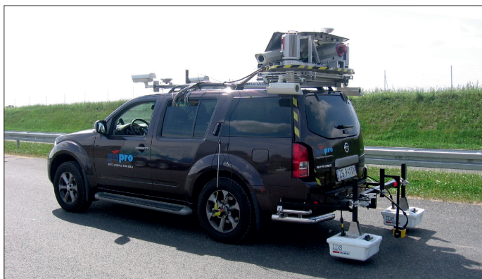
Fot. 1. Pojazd z zamontowanym systemem MMS/MLS
