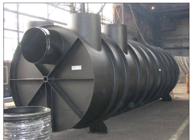
Fot. 3. Stalowy separator koalescencyjny substancji ropopochodnych z wkładem lamelowym
