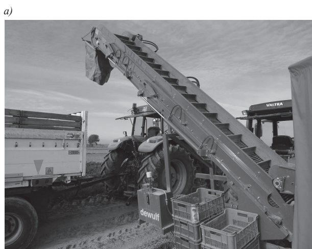
Rys. 4. Przenośnik załadowniczy do napełniania skrzyniopalet umieszczonych na przyczepie (a) wyposażony w elastyczny kosz zasypowy (b) Fig. 4. An elevator with an elastic funnel chute (b) for loading carrot roots into pallet boxes on a trailer (a)
