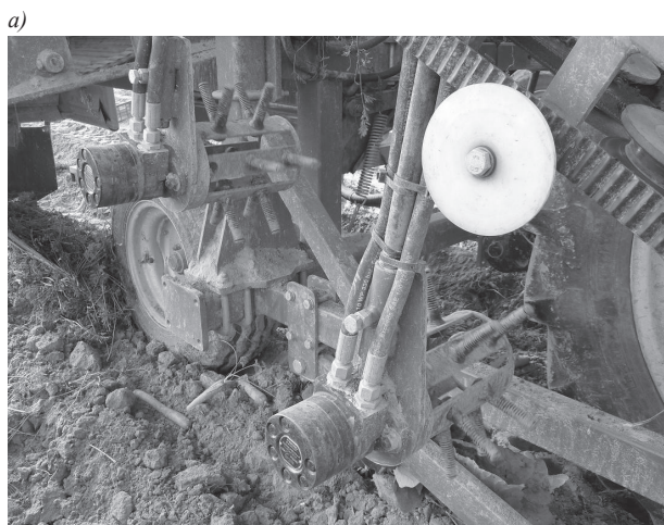
Rys. 3. Obrotowy podwójny bijakowy zespół czyszczący (a) oraz wielonożowy, rotacyjny zespół obrywający naci (b) Fig. 3. A rotary double brushing unit for cleaning the roots (a) and a rotary multi-blade topping unit (b)
