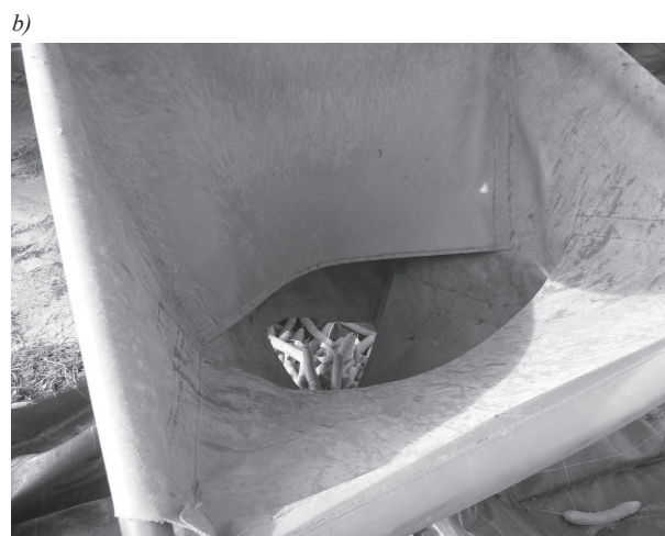
Rys. 4. Przenośnik załadowniczy do napełniania skrzyniopalet umieszczonych na przyczepie (a) wyposażony w elastyczny kosz zasypowy (b) Fig. 4. An elevator with an elastic funnel chute (b) for loading carrot roots into pallet boxes on a trailer (a)
