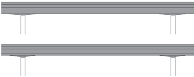
Rys. 3. Usunięcie efektu wygięcia krawędzi przęsła według [24]
