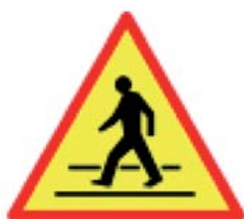
Rys. 1. Znak a-16. Przejście dla pieszych – ostrzega przed przejściem dla pieszych. Umieszcza się go przed przejściem bez sygnalizacji świetlnej na drogach o dopuszczalnej prędkości powyżej 60 km/h lub przed przejściem poza skrzyżowaniami, gdy może nie być widoczne odpowiednio wcześniej
