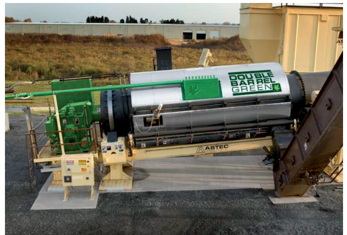
Fot. 3. Ogólny widok bębna suszarki wytwórni ASTEC Double Barrel Green. W centrum widoczny jest zespół dysz do wtryskiwania wody i asfaltu [3]
