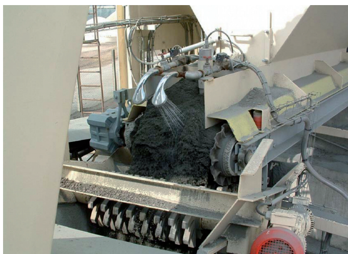
Fot. 6. Dodatkowe zwiększanie wilgotności kruszywa frakcji piaskowej poprzez skropienie wodą [3]
