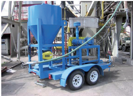
Fot. 11. Przewoźny silos zeolitu współpracujący z wytwórnią mma o działaniu ciągłym [11]
