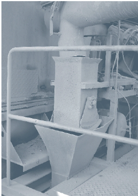
Fot. 5 – Zasobnik wagowy służący do odmierzania niezbędnej ilości środka – wytwórnia mma w Niemczech [3]
