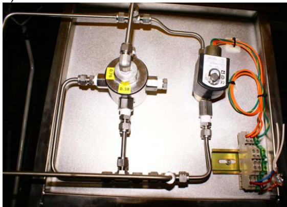
Rys.14. System do utrzymywania stałego ciśnienia cząstkowego w komorze DZWONIEC Doświadczalnego Głębokowodnego Kompleksu Nurkowego DGKN-120:
