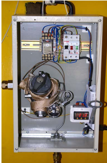
Rys.8.a)Symulator emisji \text{CO}_2 azotu b)na stanowisku badawczym na komorze DZWONIEC kompleksu nurkowego DGKN-120
