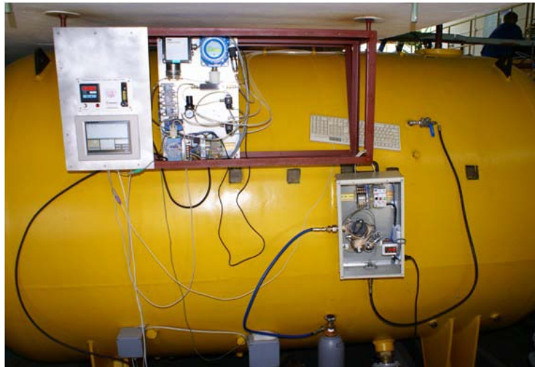
Rys.8.a)Symulator emisji \text{CO}_2 azotu b)na stanowisku badawczym na komorze DZWONIEC kompleksu nurkowego DGKN-120
