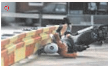
Fot. 6. Bariera stalowa z osłoną zabezpieczającą, kąt najechania 25°, pozycja pozioma (ślizgowa) motocyklisty [1]
