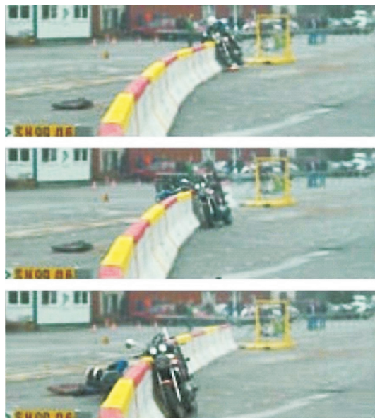
Fot. 2. Bariera betonowa, kątnajechania 12°, pozycja pionowa motocyklisty [2]
