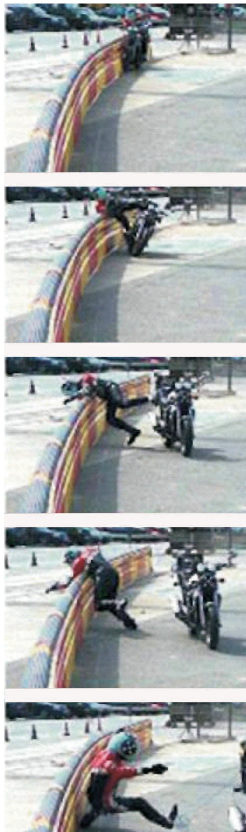
Fot. 3. Bariera stalowa z osłoną zabezpieczającą, kąt najechania 12°, pozycja pionowa motocyklisty
