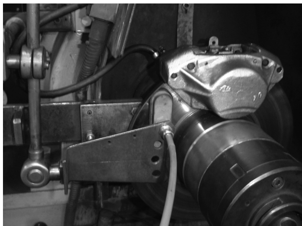
Rys. 4. Widok zestawu hamulcowego i położenia ssawki Fig. 4. View of the brake assembly and the location of the suction nozzle
