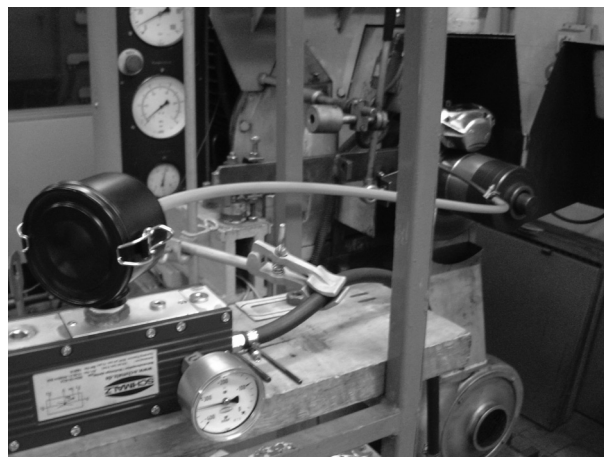
Rys. 5. Widok zestawu podciśnieniowego – dysza eżektorowa z wakuometrem i filtrem połączonym z ssawką Fig. 5. View of the negative pressure assembly – the ejector nozzle with vacuum gauge and filter connected to the suction nozzle
