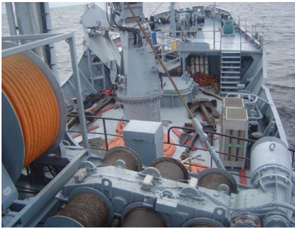
Fot. 2. Widok na śródokręcie okrętu ratowniczego. Widoczne na pierwszym planie wciągarki szeciobębnowe i pępowina dzwonu nurkowego. Niżej wyposażenie do stawiania kotwiczowiska redowego.
