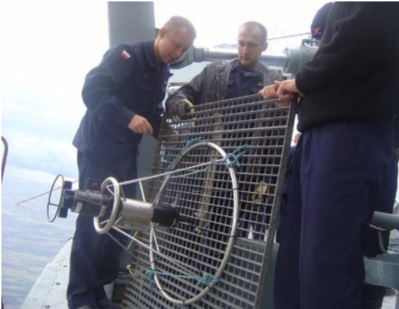
Fot. 6. Mocowanie sonaru do podestu nurkowego.
