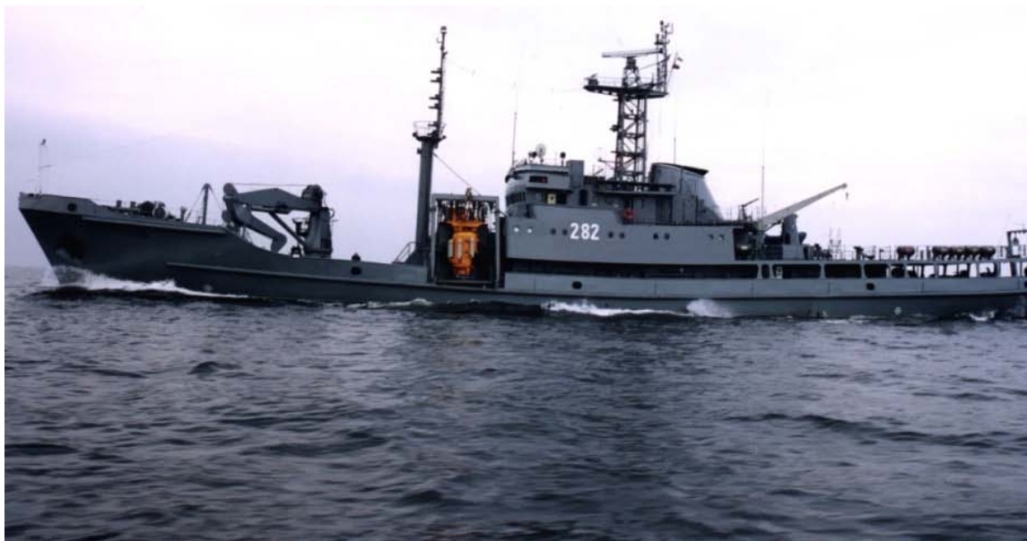
Fot. 1. ORP „Lech”. Sylwetka dużego okrętu ratowniczego projektu 570. Platforma MW RP do prowadzenia nurkowań głębokowodnych.
