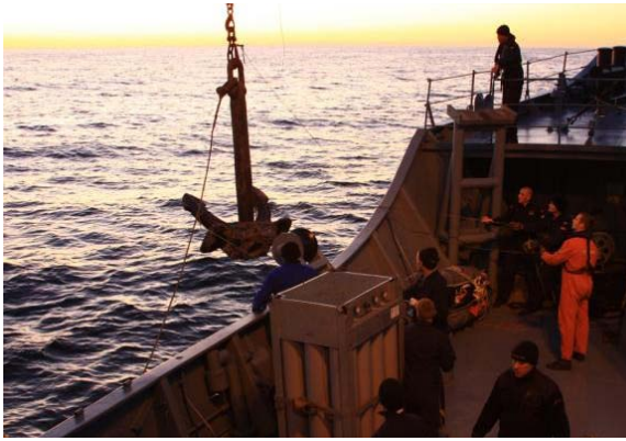
Fot. 4. Prace pokładowe związane z rozstawieniem kotwicowiska redowego.
