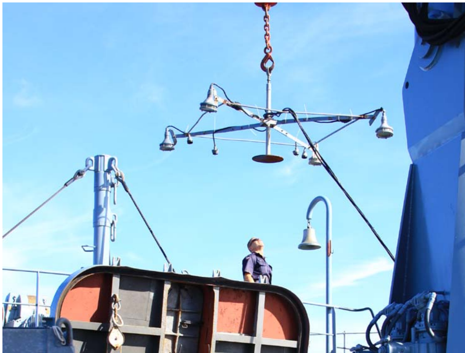
Fot. 15. Zestaw do dodatkowego oświetlenia podwodnego przed zanurzeniem.
