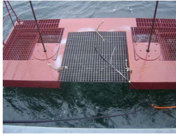
Fot. 7. Podest nurkowy wraz z zamontowanym w sonarem.
