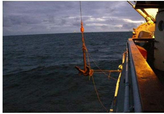
Fot. 5. Wychylona za burtę kotwica, tuż przed jej zrzućeniem na zaplanowanej pozycji.
