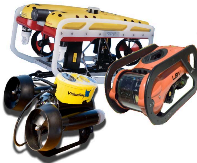
Rys. 14. Pojazdy Micro ROV: VideoRay – na dole po lewej, LBV – na dole po prawej i Compact ROV: Falcon – na górze (rysunek bez skali)
