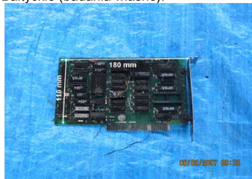
fot. 10. Obwód drukowany – obiekt podwodny zatopiony techniczny, akwen śródlądowy, zdjęcie po wyjęciu z wody (badania własne)
