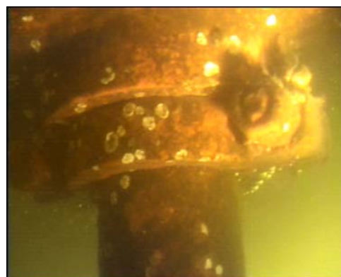
fot. 6. Trzpień płetwy sterowej – obiekt podwodny zanurzony częściowo tj. podwodna część kadłuba jednostki pływającej (badania własne)
