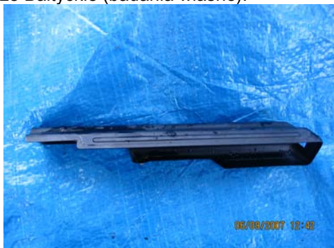
fot. 9. Pokrywa komory zamka od kbk AK – obiekt podwodny militarny, akwen śródlądowy, zdjęcie po wyjęciu z wody (badania własne)
