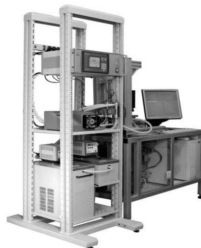
Rys. 4. Widok stanowiska do badań zmęczeniowych wypełnień stomatologicznych
