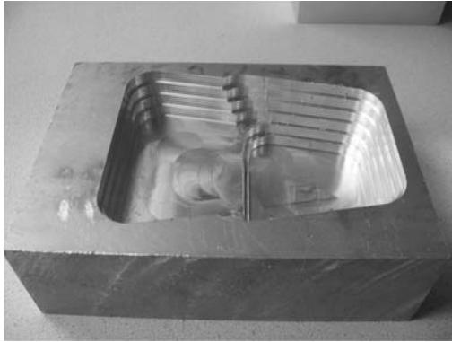
Rys. 6. Detal po obróbce z wykorzystaniem narzędzia CoroMill Plura R216 33-25040-AJ25U
