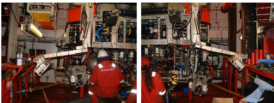
Rys. 5. Sposób mocowania w celu uzyskania lepszej definicji podparcia. Mocowanie DeltaT na pojeździe Pioneer11.
