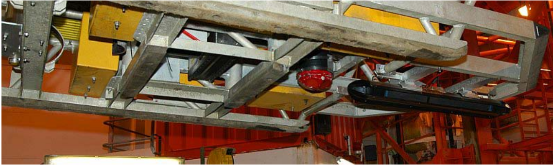
Rys. 3. Zestaw 8125, Log dopplerowski, sonar boczny zamontowany pod pojazdem Herkules 10.
