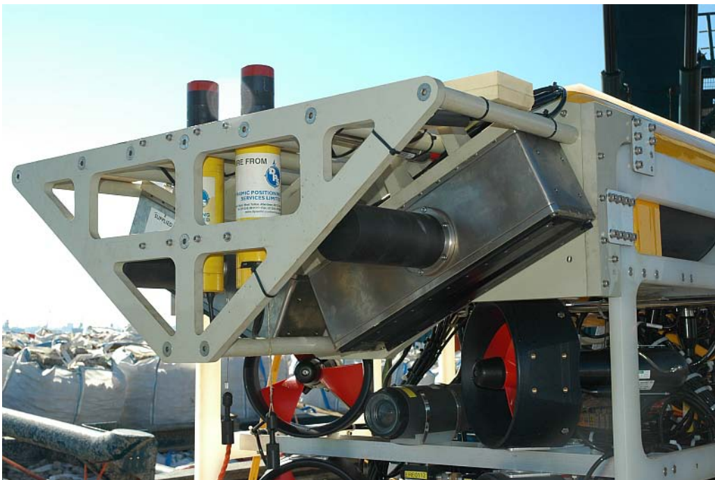
Rys. 4. Sposób mocowania w celu uzyskania szerszego pasa pokrycia, przy jednocześniej możliwości bliskiego kontaktu z rurociągiem dla inspekcji wizualnej. 2xReson SEABAT 8125 na pojeździe Seaeeye Panther.
