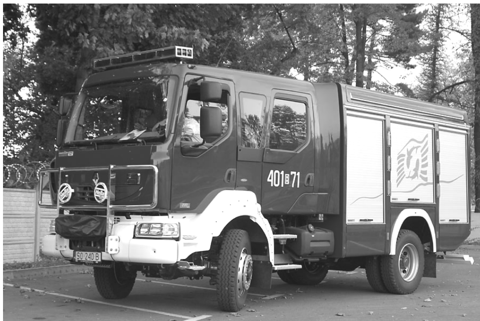
Rys. 4. Średni samochód ratownictwa wodnego Renault Midlum 220.14 (4x4).
