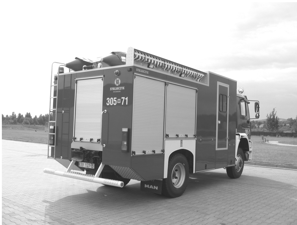
Rys. 11. Ciężki samochód ratownictwa wodnego MAN LE 14.280 BB.
