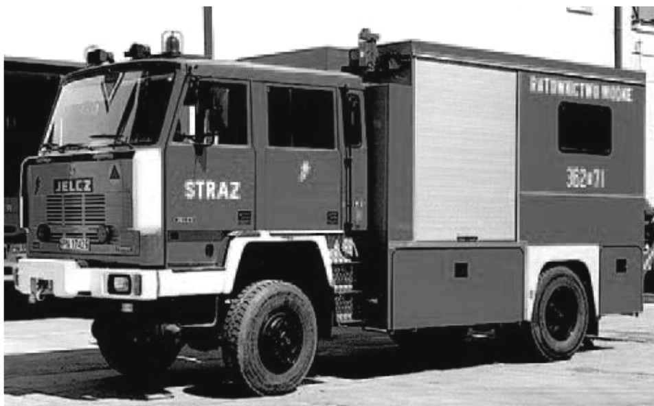
Rys. 3. Ciężki samochód ratownictwa wodnego Jelcz 442 DS (4x4).
