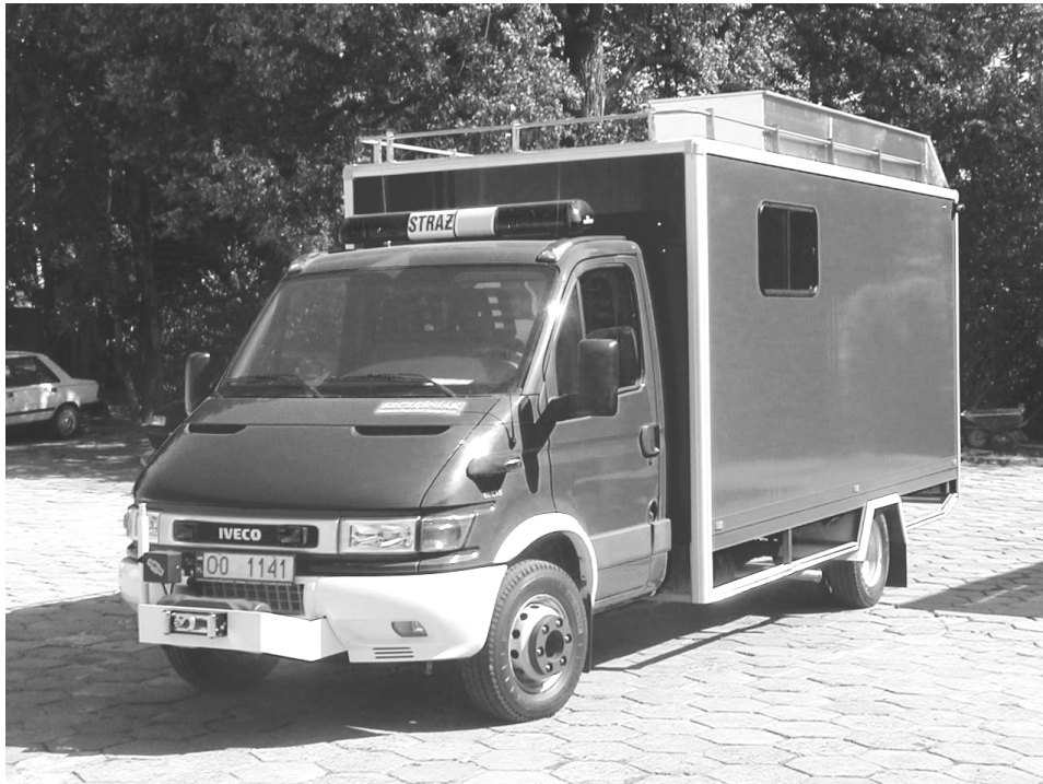
Rys. 5. Lekki samochód ratownictwa wodnego Iveco Daily 65C15 (4x2).
